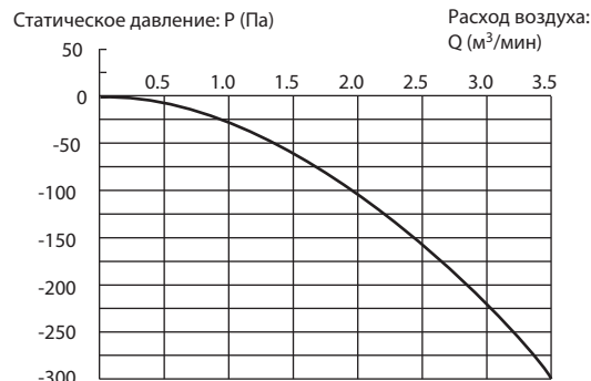
Расход приточного воздуха (подача воздуха в блок)
