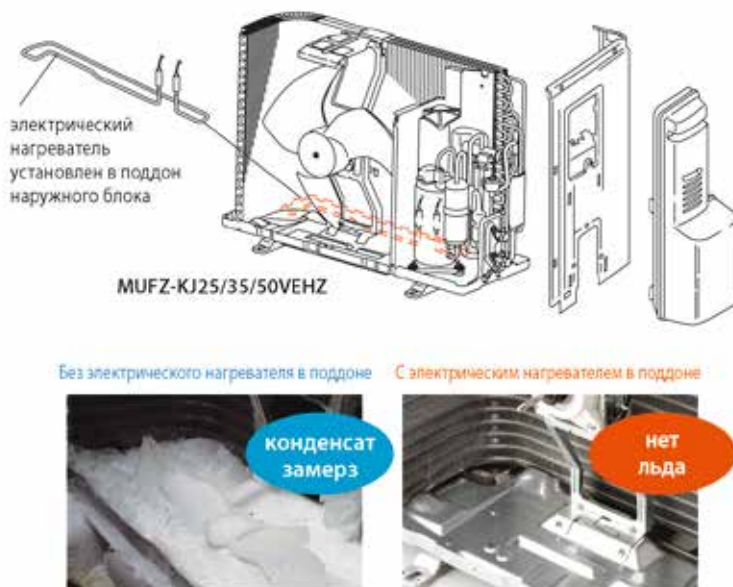
Рис. 4. Электрический нагреватель в поддоне наружного блока
